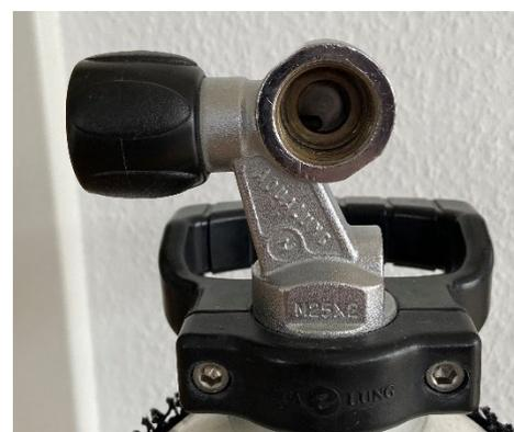
Doppelflasche ausgestattet sein. Manche Flaschenventile sind mit einer **Berstscheibe** ausgestattet, die bei Überdruck zerreißt und den die Luft entweichen lässt. Dieser Mechanismus wird eingebaut, damit die Flasche nicht herumfliegt, wenn Luft aufgrund eines Überdrucks austritt.
